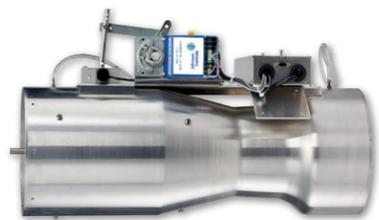
As válvulas Venturi da Johnson Controls mantêm o fluxo de ar desejado, independentemente da pressão do duto. Isso é realizado com um cone e pistão com mola dentro da válvula. Esse mecanismo mantém a vazão volumétrica constante à medida que o ar viaja através da válvula e a pressão do duto varia.
